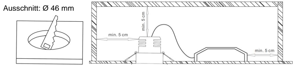
2. Sicherung im Sicherungskasten ausschalten. Leuchte nur bei ausgeschaltetem Treiber anklemmen.
