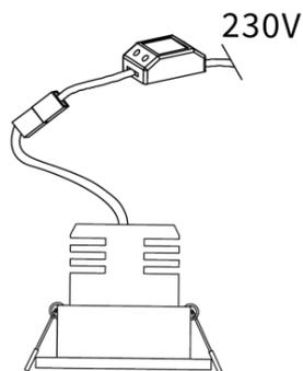
3. Treiber an Stromzuleitung anklemmen und Leuchte, wie dargestellt, in die Decke einsetzen
